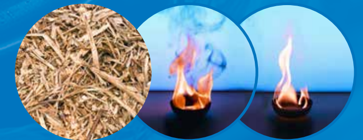
HVO op basis van hernieuwbare grondstoffen zoals houtpulp (foto links) verbrandt zeer schoon. Linker verbranding betreft conventionele diesel, rechts betreft HVO.
